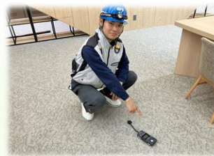
▲名工建設(株)様現場にて 仕上げ確認・照度測定中
