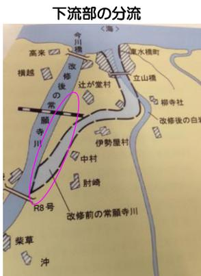
▲常願寺川の河道をまっすぐにする事で流水のエネルギーを強め、中流に堆積した土砂をその力で海まで流してしまおうと考えていたようです。
